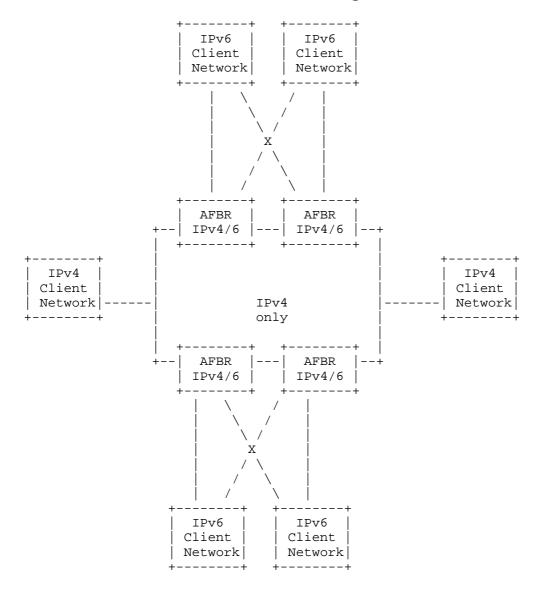
Figure 1: IPv6-over-IPv4 Scenario
