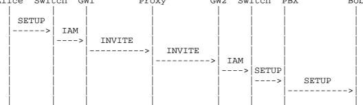
Figure 2: ISDN-SIP-ISDN Interconnection
